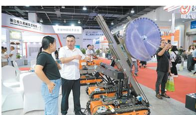
需要人工推着走的工具支架变成了可遥控的履带车,履带车又与大型切割工具结合,更加安全省力,也能适用于泥地、坡地或楼梯。
