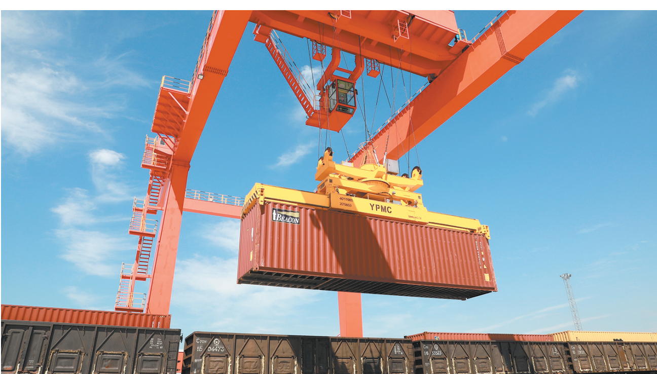
吊装集装箱到列车上
