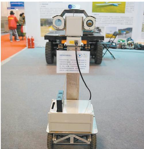
左眼是红外摄像头,检测畜禽体温,右眼是RGB摄像头,记录畜禽行为,脑袋上是深度相机,定位畜禽空间位置,底盘有AGV、轮式和履带式三种配置,以适应不同地区或地域的作业需求,底座上的方形控制柜是智慧大脑,汇集收集到的信息上传到控制终端。这是浙江大学带来的巡检与识别机器人,适用猪、羊、牛、鸡、鸭、鹅等畜禽。
