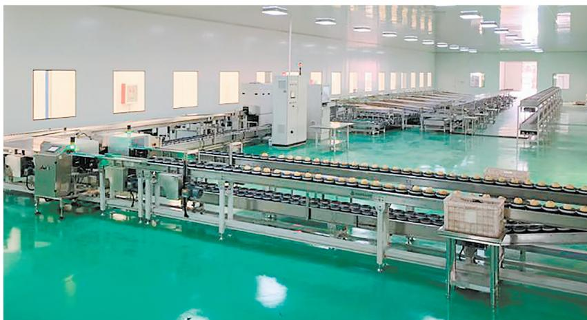
选,每个水果单独在柔性果托上进行分选,水果与果托在传输过程中紧密贴合,不产生相对运动,能完全避免水果在分选过程中产生磕碰。
