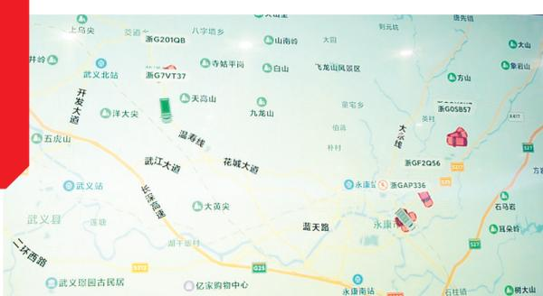
在浙江途达后勤办公室的电子屏幕上,公司车辆的行驶路径和相关信息一目了然(如上图)。这是该公司去年新引进的安智连智能车辆定位系统,主要用于掌握公司车辆去向、行驶情况和查询车辆基本信息。据介绍,通过这个智能车辆定位系统,工作人员不仅能精准看到车辆的行驶轨迹和基本信息,还可以查看车辆实时行驶速度,查询车辆违章情况。不单单是电脑端,手机端也可以
