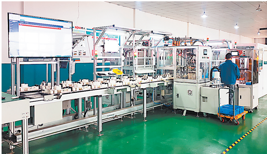
博大公司开槽机自动化生产线
