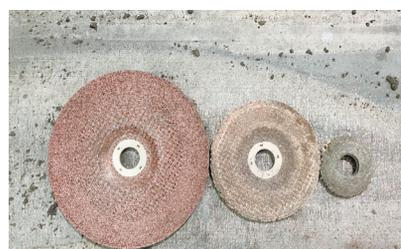
从左至右为正常尺寸磨光片,工友使用后的磨光片,冯俊使用后的磨光片。而半径越大,操作手感越好,打磨的效率也越高。所以,很多工友大多在磨光片半径还剩6厘米时就换新的。而冯俊,会把每个磨光片用到砂带几乎磨完,半径只剩3厘米。
