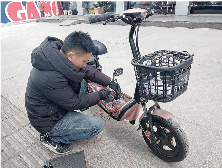
维修师傅在检测电池性能
