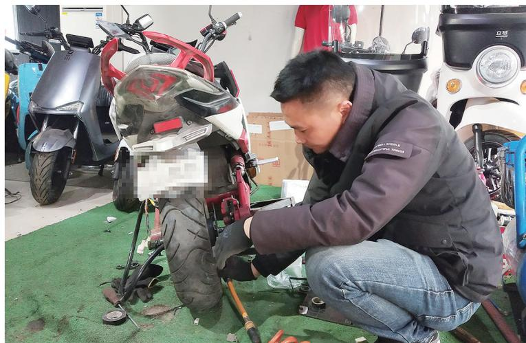
胎作用。他将自补液挤进皮损处后,再在破损处补上一条胶条,给予双重保护。
