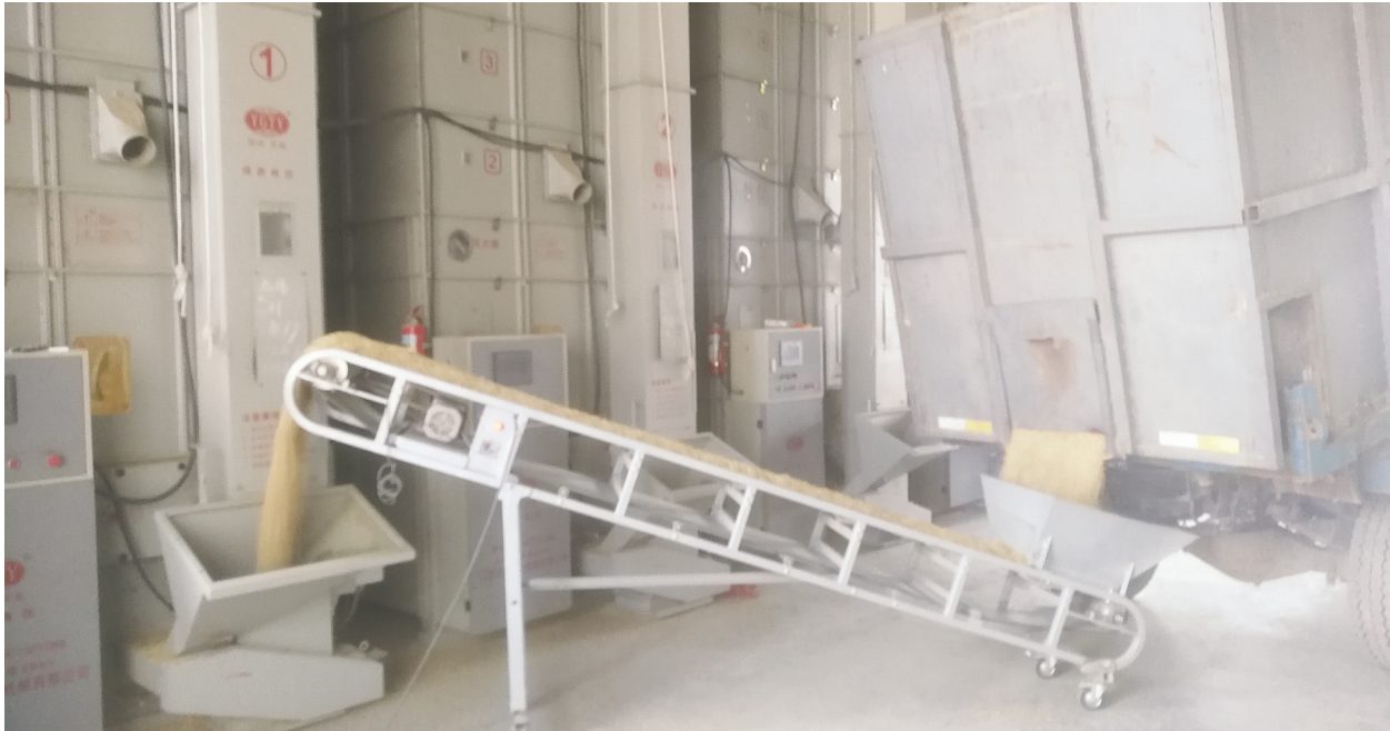
稻谷通过上粮皮带输送机进入烘干机
